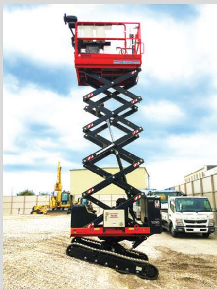
傾斜地でもデッキが自動で水平になる遠隔操作式カメラ車
