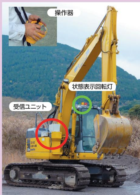
既存のバックホウを遠隔操作機器に
