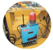
RFIDタグを携帯した作業員が IDガードマン警報装置に接近すると ブザー付回転灯でオペレーターに 危険を知らせます!
