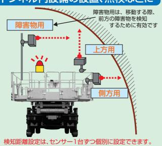
センサー設置パターン<例> 天井の低い場所での重機作業に 上方用 後方用
